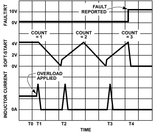
FIGURE 8. OVER-CURRENT OPERATION
