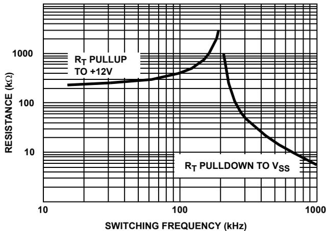
FIGURE 4. R<sub>T</sub> RESISTANCE vs FREQUENCY
