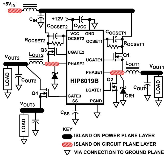
**FIGURE 10. PRINTED CIRCUIT BOARD POWER PLANES AND ISLANDS**
