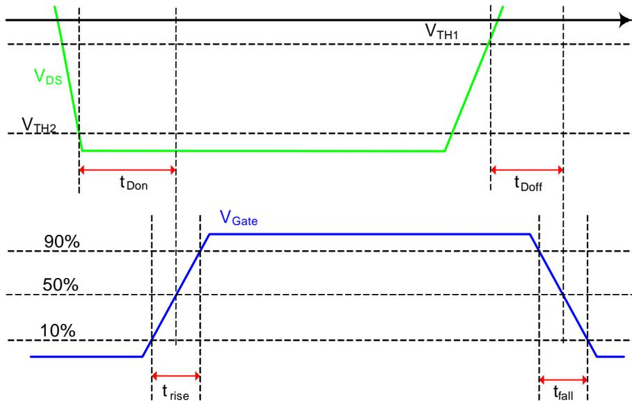
**Fig. 15 - Timing Diagrams**
