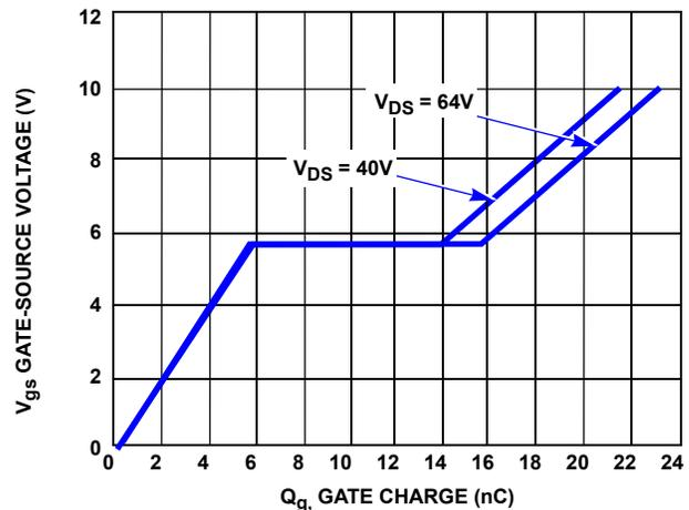
FIGURE 20. MOSFET GATE CHARGE vs GATE VOLTAGE
