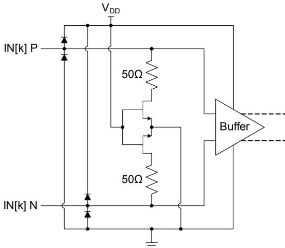
FIGURE 25. CML INPUT EQUIVALENT CIRCUIT FOR THE QLX4600-S30
