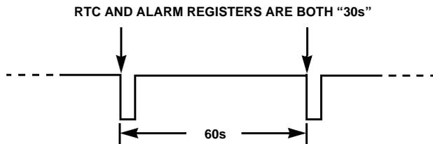
FIGURE 16.  $\overline{\text{IRQ}}/\text{F}_{\text{OUT}}$  WAVEFORM
