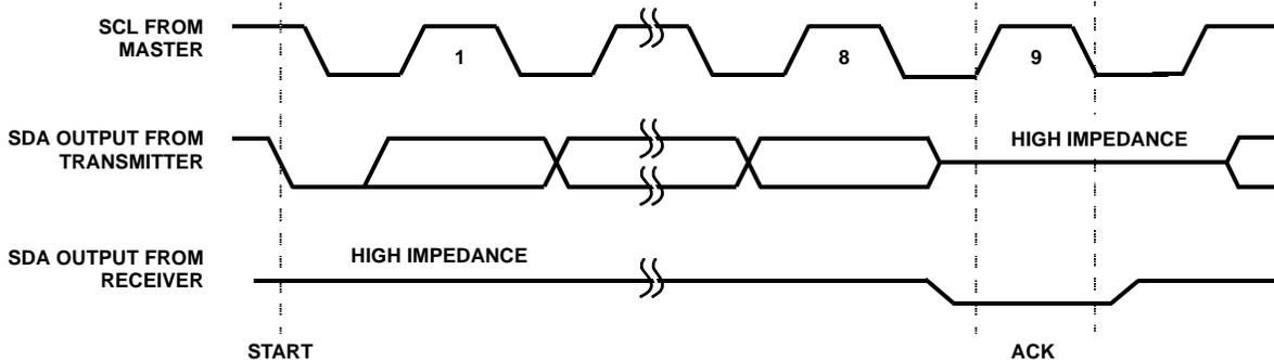
FIGURE 18. ACKNOWLEDGE RESPONSE FROM RECEIVER
