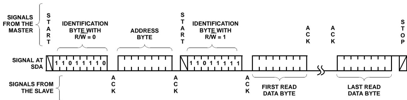
FIGURE 21. READ SEQUENCE (CSR SLAVE ADDRESS SHOWN)
