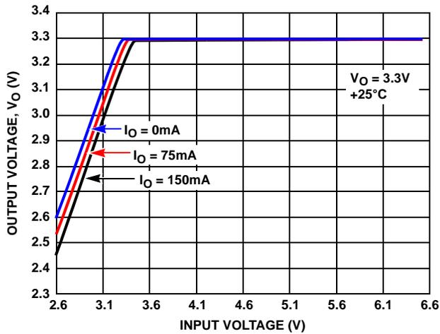
FIGURE 5. DROPOUT VOLTAGE vs INPUT VOLTAGE (3.3V OUTPUT)
