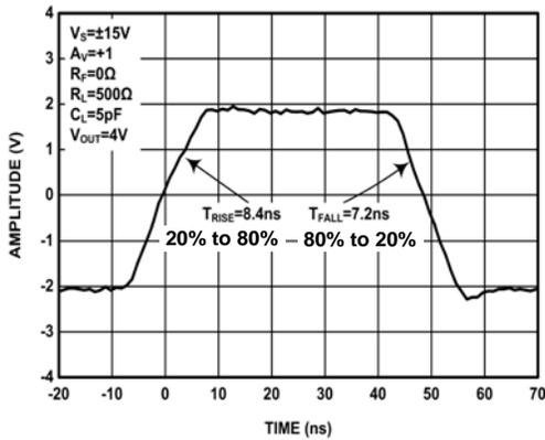
FIGURE 23. LARGE SIGNAL RISE AND FALL TIMES
