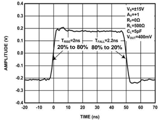
FIGURE 24. SMALL SIGNAL RISE AND FALL TIMES
