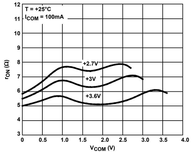
FIGURE 14. ON-RESISTANCE vs SWITCH VOLTAGE; COM1B AND COM4B
