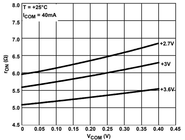
FIGURE 8. ON-RESISTANCE vs SWITCH VOLTAGE; COM2, COM3
