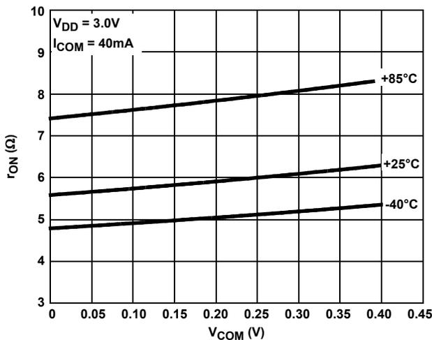
FIGURE 7. ON-RESISTANCE vs SWITCH VOLTAGE; COM2x AND COM3x
