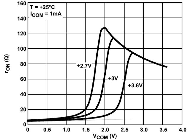
FIGURE 10. ON-RESISTANCE vs SWITCH VOLTAGE; COM2x AND COM3x
