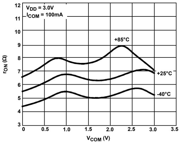
FIGURE 13. ON-RESISTANCE vs SWITCH VOLTAGE; COM1B AND COM4B
