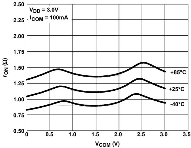
FIGURE 11. ON-RESISTANCE vs SWITCH VOLTAGE; COM1A AND COM4A
