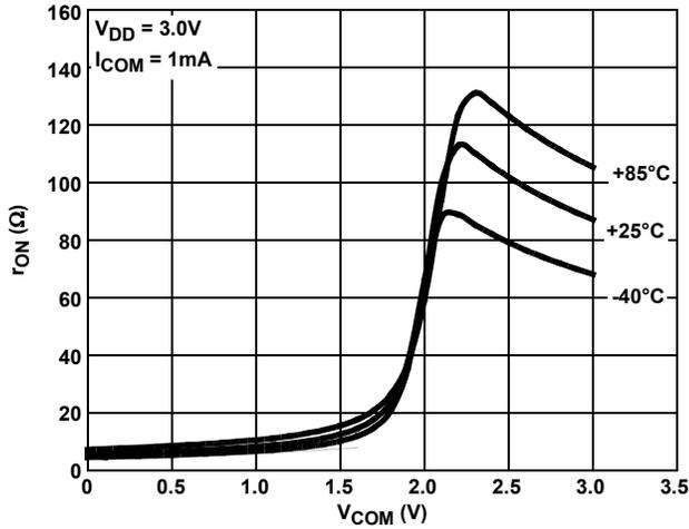
FIGURE 9. ON-RESISTANCE vs SWITCH VOLTAGE; COM2x AND COM3x
