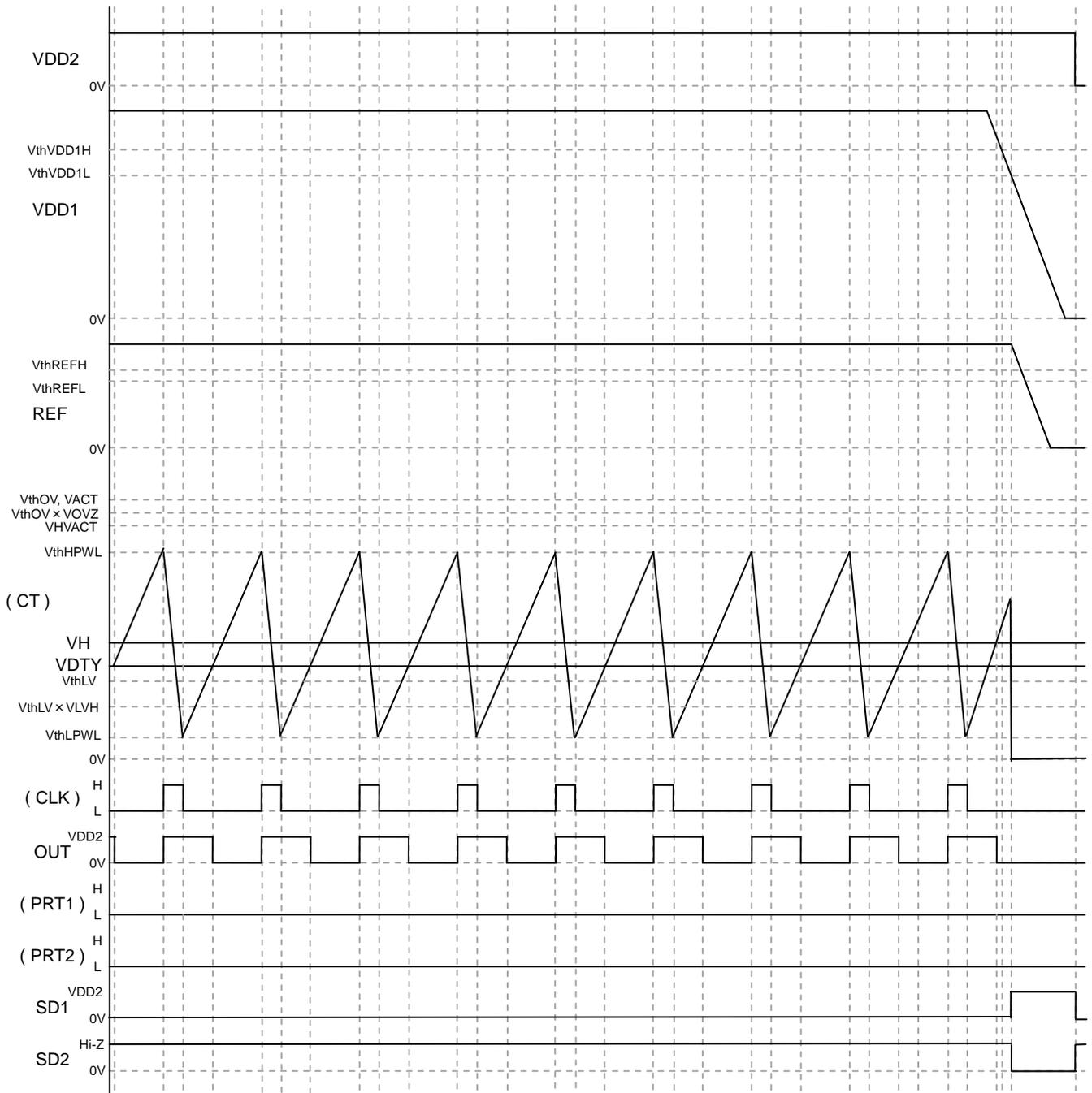
Figure 5. VDD1 Stop to VDD2 Stop Timing Chart
