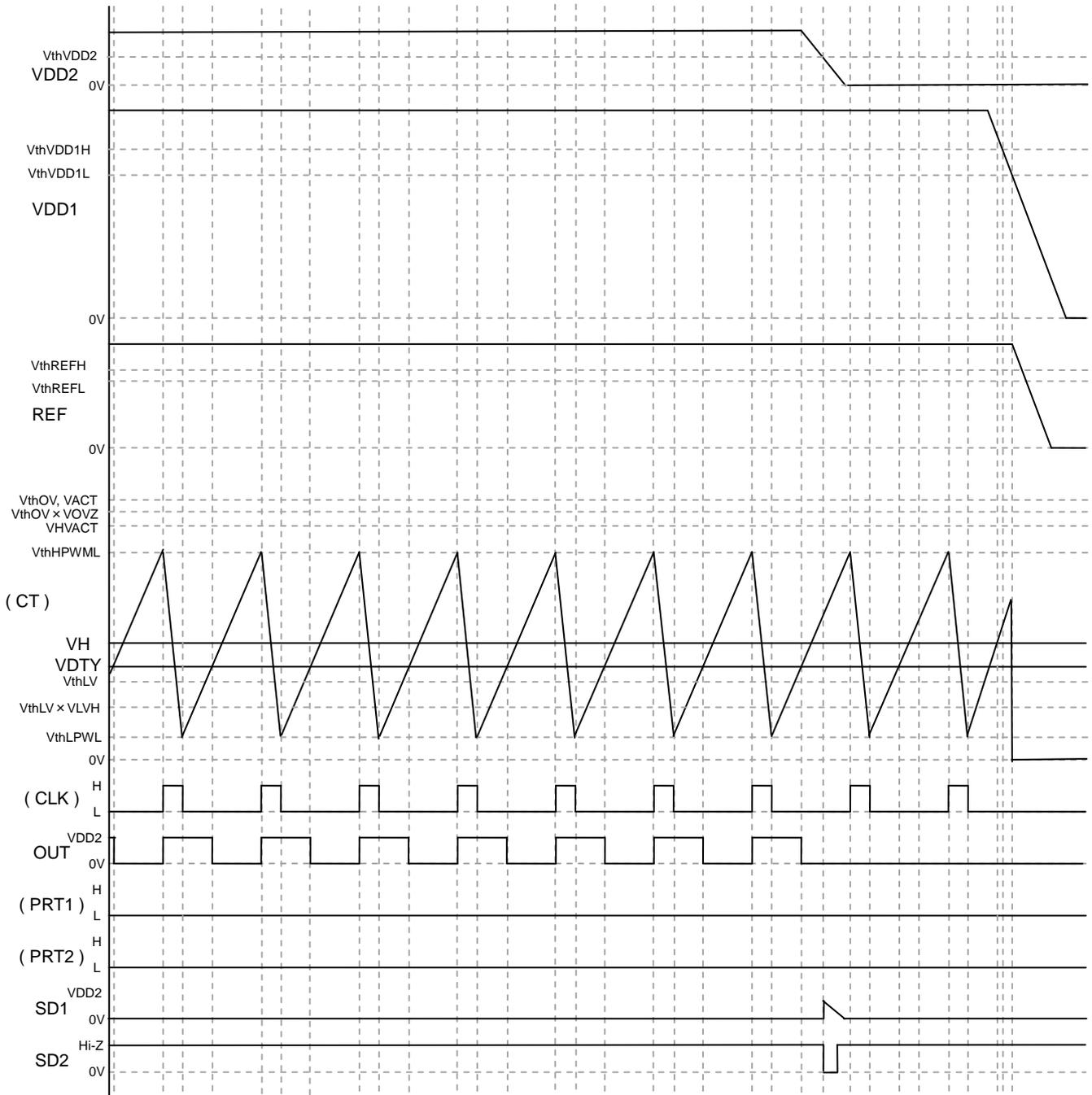
Figure 6. VDD2 Stop to VDD1 Stop Timing Chart
