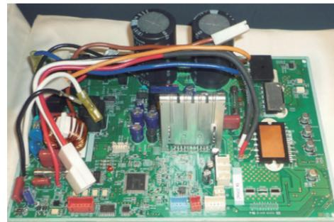
**Fig. 2 Inverter module**
