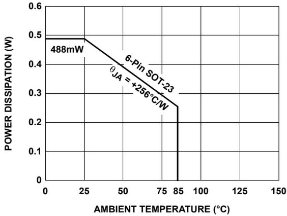
FIGURE 24. PACKAGE POWER DISSIPATION vs AMBIENT TEMPERATURE
