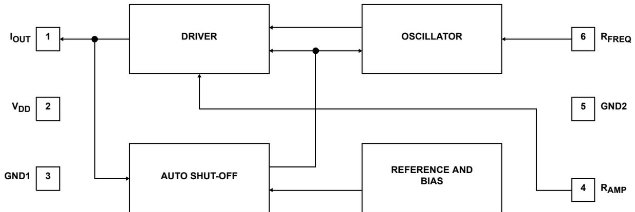
FIGURE 1. BLOCK DIAGRAM
