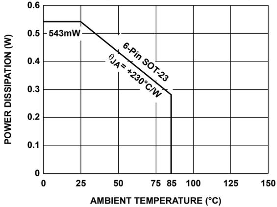
FIGURE 25. PACKAGE POWER DISSIPATION vs AMBIENT TEMPERATURE
