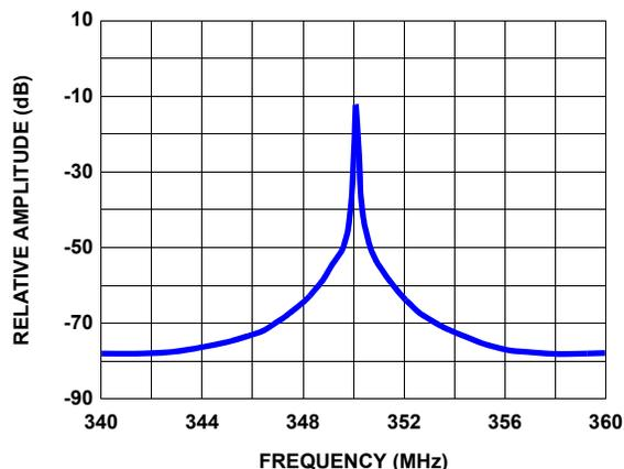
FIGURE 20. OUTPUT SPECTRUM-WIDEBAND
