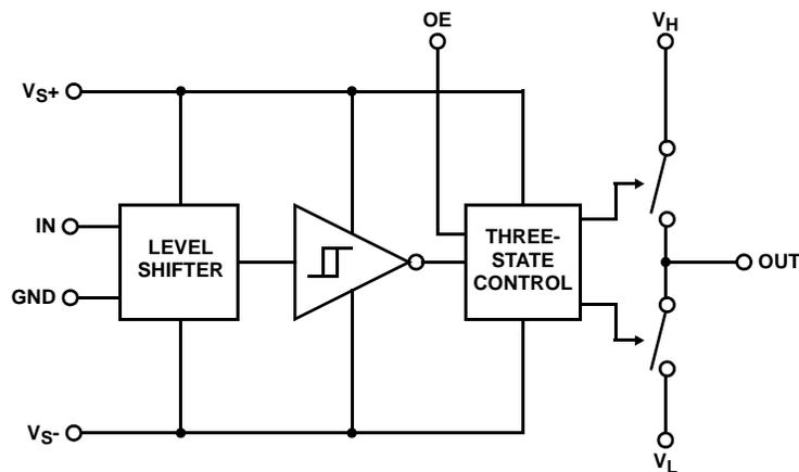
FIGURE 15. BLOCK DIAGRAM
