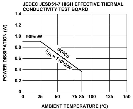
FIGURE 12. PACKAGE POWER DISSIPATION vs AMBIENT TEMPERATURE
