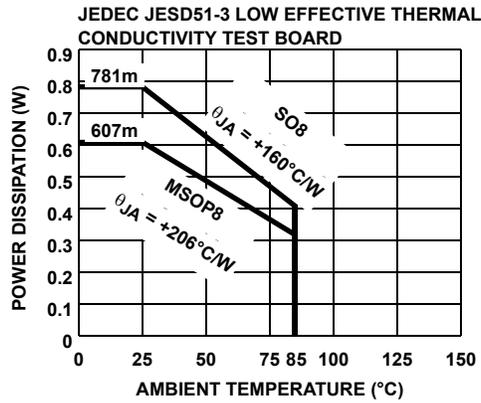
FIGURE 37. PACKAGE POWER DISSIPATION vs AMBIENT TEMPERATURE
