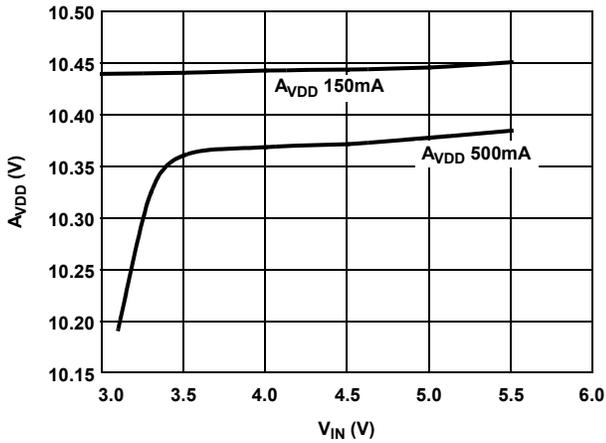
FIGURE 3. LINE REGULATION A<sub>VDD</sub> vs V<sub>IN</sub>
