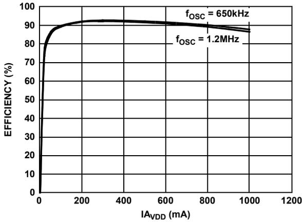
FIGURE 1. A<sub>VDD</sub> EFFICIENCY vs I<sub>A\_VDD</sub>
