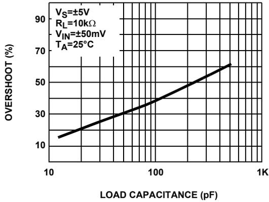
FIGURE 19. SMALL SIGNAL OVERSHOOT vs LOAD CAPACITANCE
