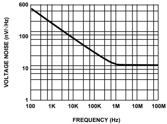
FIGURE 16. INPUT VOLTAGE NOISE SPECTRAL DENSITY vs FREQUENCY
