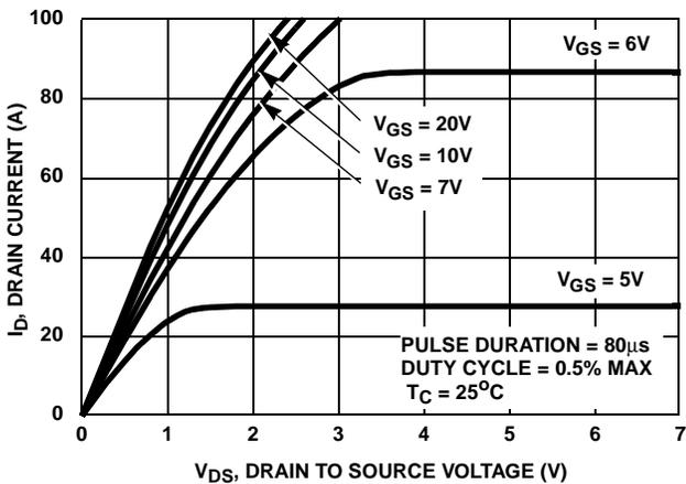
FIGURE 7. SATURATION CHARACTERISTICS
