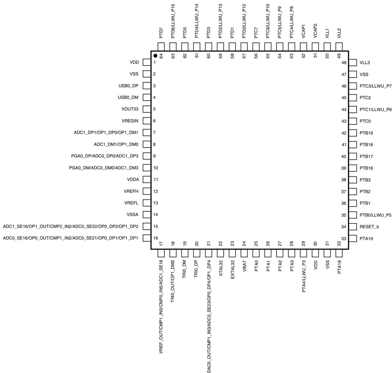
Figure 10-2. K51 64 LQFP/QFN Pinout Diagram
