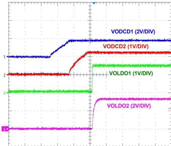
FIGURE 13. START-UP SEQUENCE ( $V_{IN} = 4.2V$ , NO LOAD)
