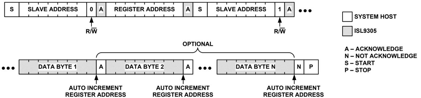
FIGURE 7. I<sup>2</sup>C READ SPECIFYING REGISTER ADDRESS
