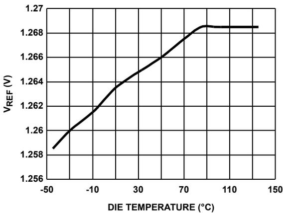
FIGURE 13. V<sub>REF</sub> vs DIE TEMPERATURE
