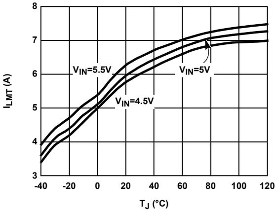
FIGURE 11. CURRENT LIMIT vs T<sub>J</sub>
