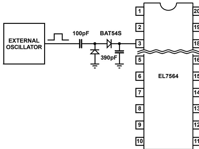
FIGURE 23. OSCILLATOR SYNCHRONIZATION
