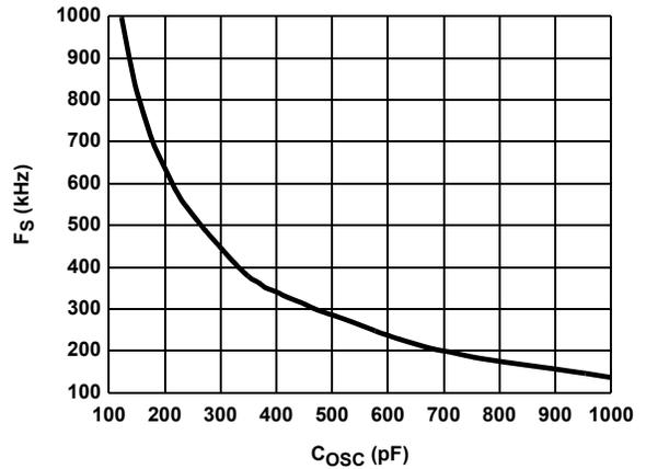
FIGURE 10. SWITCHING FREQUENCY vs C<sub>OSC</sub>
