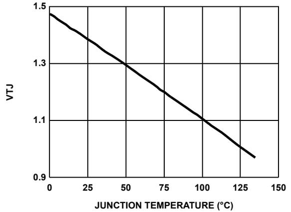
FIGURE 12. V<sub>TJ</sub> vs JUNCTION TEMPERATURE
