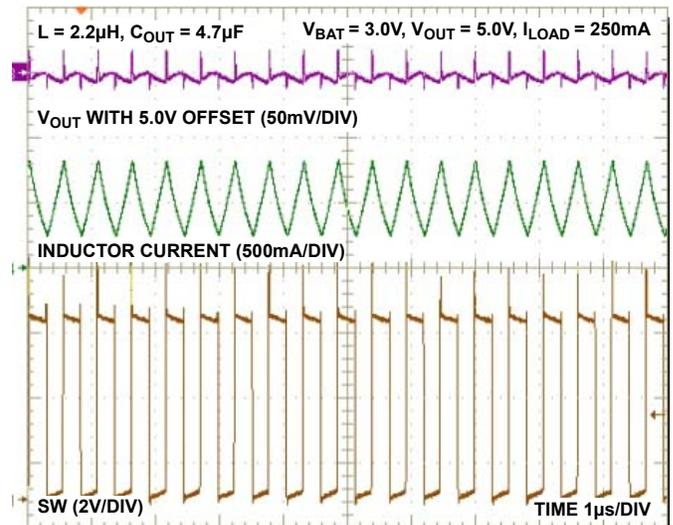
FIGURE 8. PWM WAVEFORM
