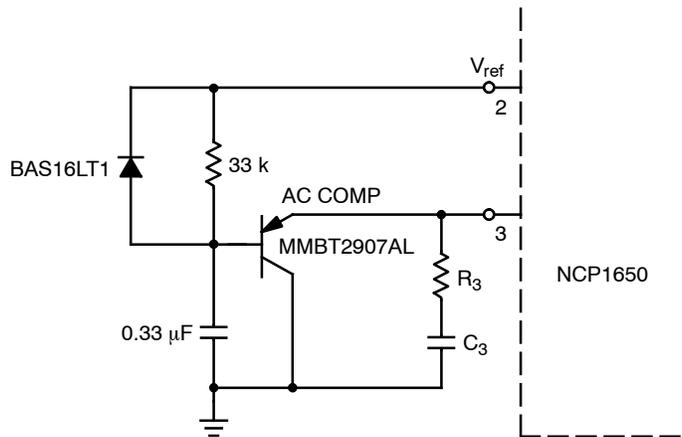
**Figure 29. Soft-Start Circuit**
