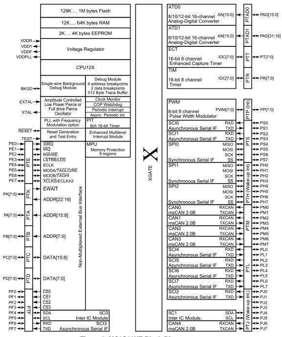
Figure 3. MC9S12XE Block Diagram
