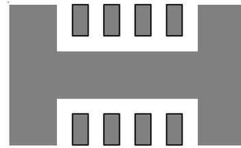
(d) Copper Area =  $50 \text{ mm}^2$ ,  $\theta_{JA} = 51^\circ\text{C/W}$
