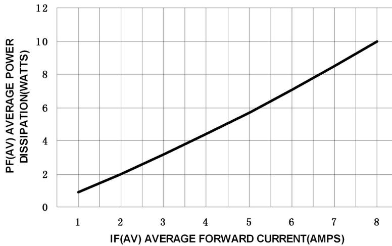
**Fig.5- Power Dissipation**
