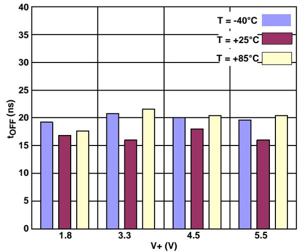
FIGURE 17. TURN - OFF TIME vs SUPPLY VOLTAGE
