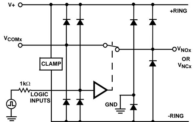
**FIGURE 7. OVERVOLTAGE PROTECTION**
