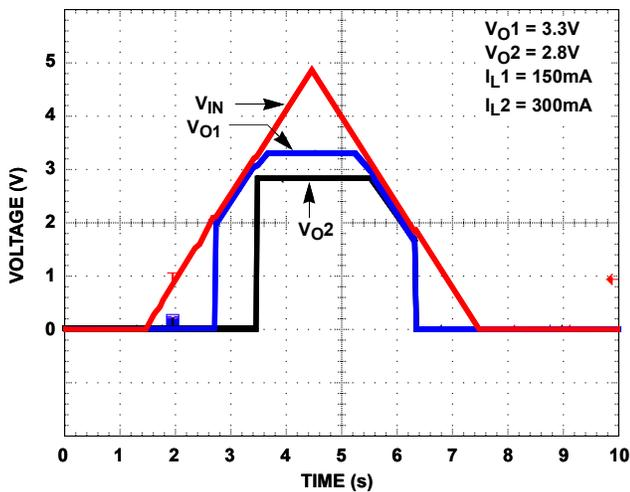
FIGURE 11. POWER-UP/POWER-DOWN
