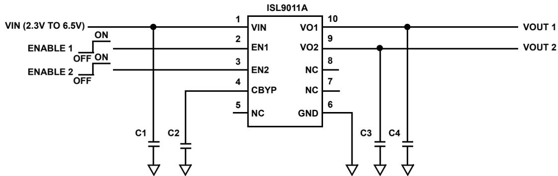
C1, C3, C4: 1 $\mu$ F X5R CERAMIC CAPACITOR
