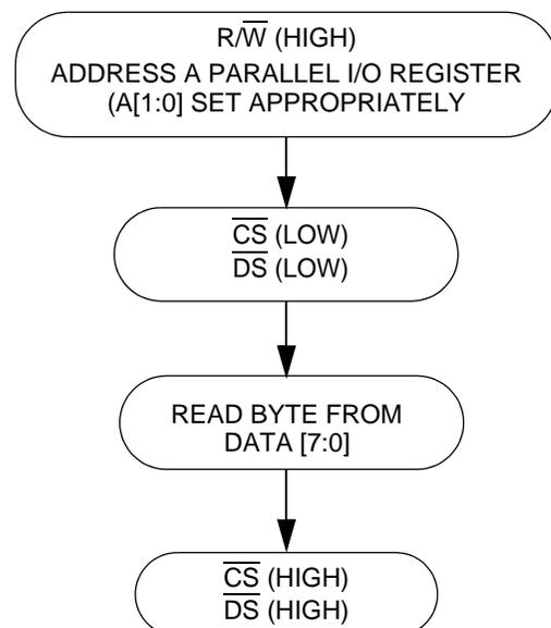
**Figure 27. Motorola Mode, One-Byte Read Flow Diagram**
