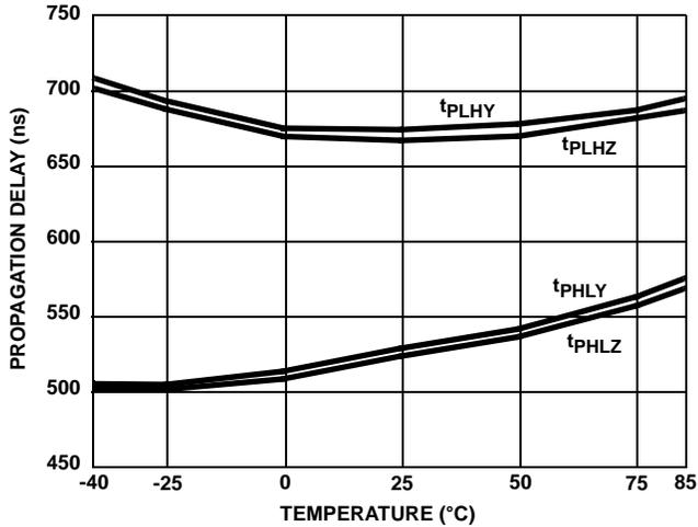
FIGURE 10. DRIVER PROPAGATION DELAY vs TEMPERATURE (ISL8488E/ISL8489E)
