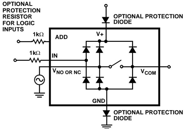
FIGURE 8. OVERVOLTAGE PROTECTION
