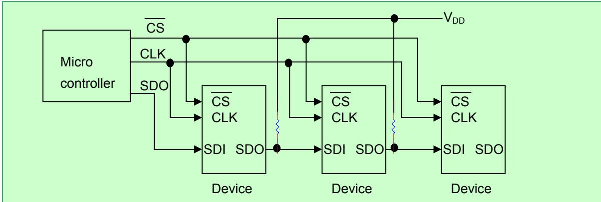
FIGURE 3 – DAISY CHAIN CONFIGURATION [10-PIN TSSOP PACKAGE ONLY]
