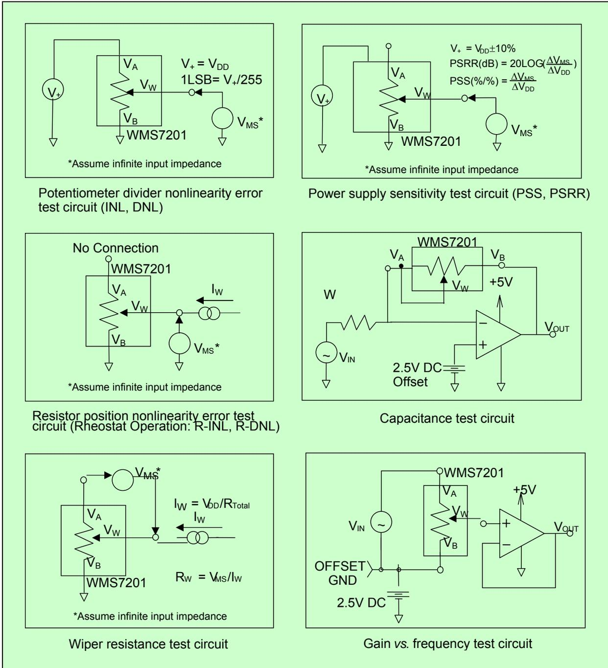
FIGURE 7 – TEST CIRCUITS
