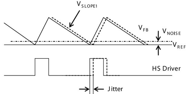
**Figure 4: PWM-Mode Jitter**
