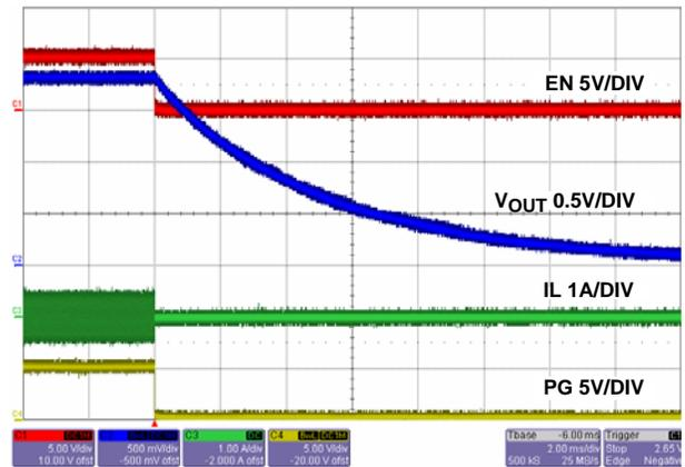
FIGURE 27. SOFT-DISCHARGE SHUTDOWN
