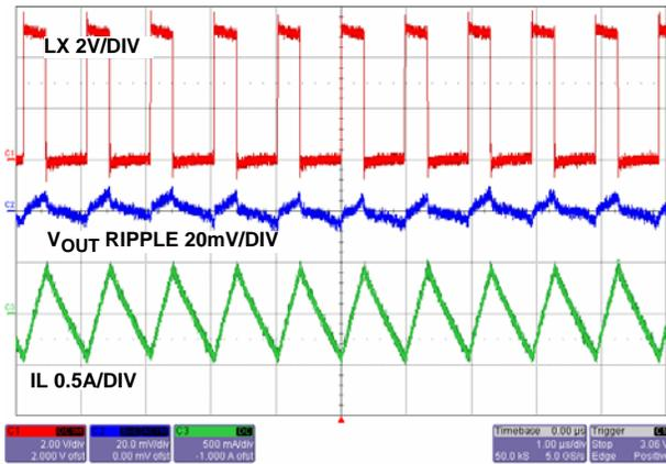
FIGURE 16. STEADY STATE OPERATION AT NO LOAD (PWM)
