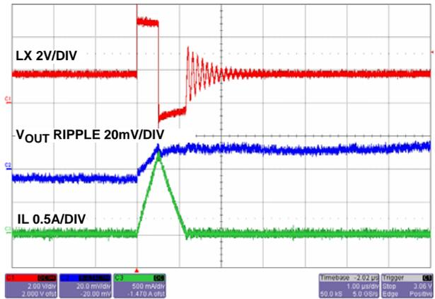
FIGURE 17. STEADY STATE OPERATION AT NO LOAD (PFM)
