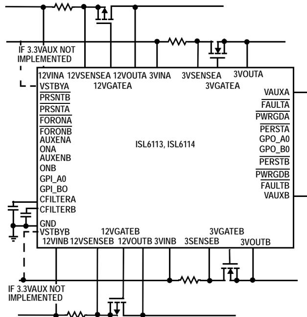
FIGURE 1. TYPICAL ISL6113, ISL6114 BLOCK DIAGRAM APPLICATION IMPLEMENTATION
