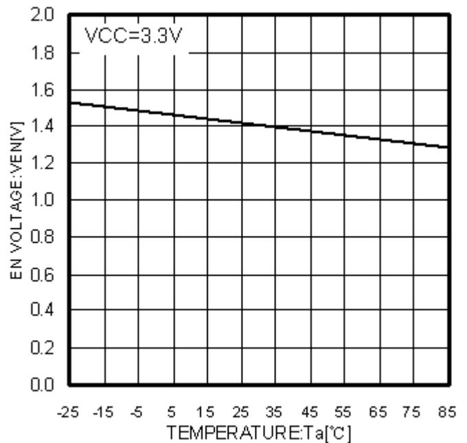
Fig.77  $T_a$ - $V_{en}$
