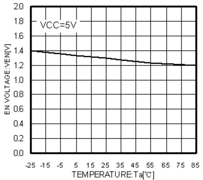
Fig.32  $T_a$ - $V_{EN}$
