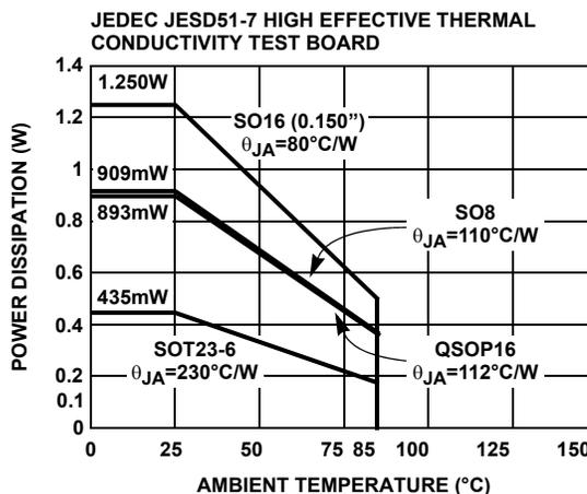
FIGURE 20. PACKAGE POWER DISSIPATION vs AMBIENT TEMPERATURE
