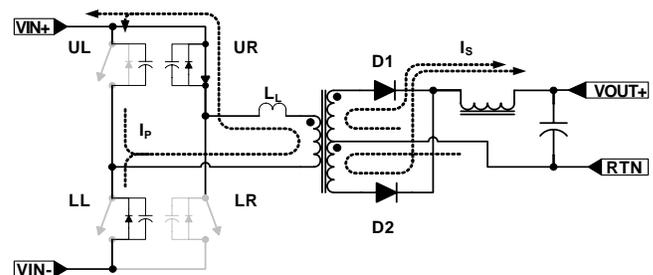
FIGURE 12. UPPER SWITCH TOGGLE AND RESONANT TRANSITION
