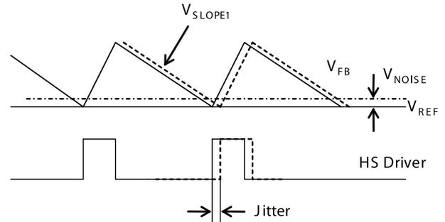
**Figure 4: PWM-Mode Jitter**
