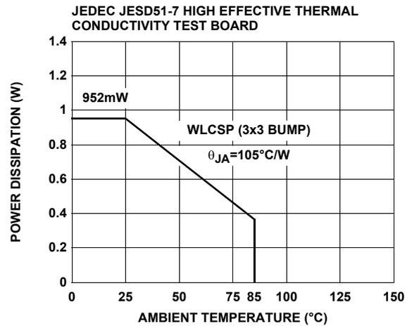
FIGURE 24. PACKAGE POWER DISSIPATION vs AMBIENT TEMPERATURE
