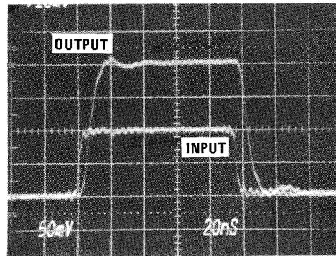
Vertical Scale: Input = 10mV/Div.; Output = 50mV/Div.
