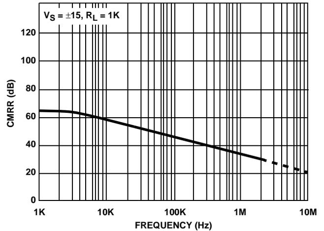
FIGURE 14. COMMON MODE REJECTION RATIO vs FREQUENCY
