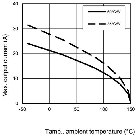
**Figure 12 – Max. iout (A) Vs Tamb. (°C)**
