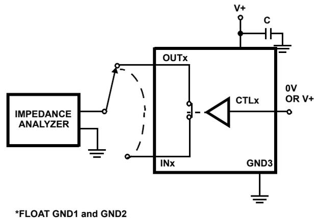
FIGURE 6. CAPACITANCE TEST CIRCUIT
