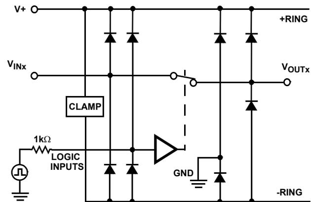
FIGURE 8. OVERVOLTAGE PROTECTION
